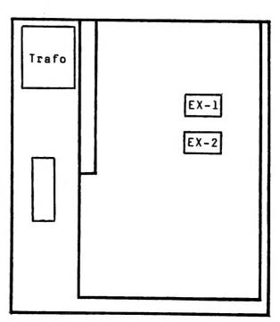
Wenn die beiden Bausteine von EXBASIC LEVEL II in ihren Fassungen stecken, dann schließen Sie den Computer wieder. Drehen Sie aber vorläufig noch nicht die Schrauben wieder ein. Stecken Sie das Netzkabel in die Steckdose und schalten Sie den Computer ein.
